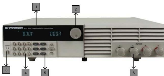
Рис. 1 Елементи контролю та керування ВК Precision 8510
