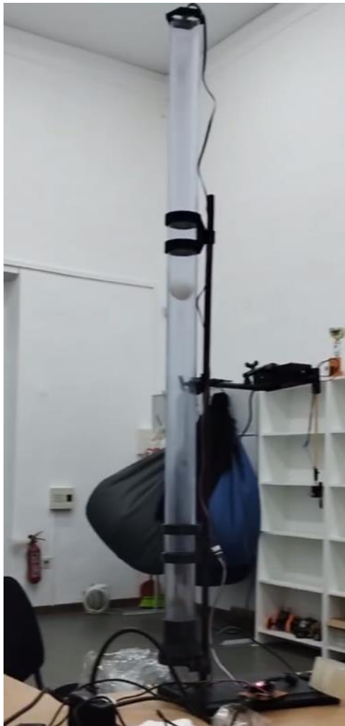
Рис. 4 Робота стенду «Аеродинамічна труба»
