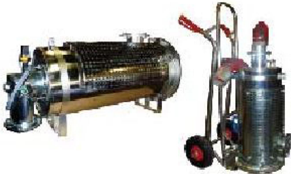
Рис. 1 Фільтраційна система «НТ» (Ступінь уловлювання: частинки розміром до 0,4 мікрона > 95%; Обсяг вихлопних газів: до 10/20/35 м 3 /хв; Температура вихлопних газів: не більше 200/250 С°; Термін служби фільтра: 100/200/200 запусків; Вага: 18/23/40 кг)
