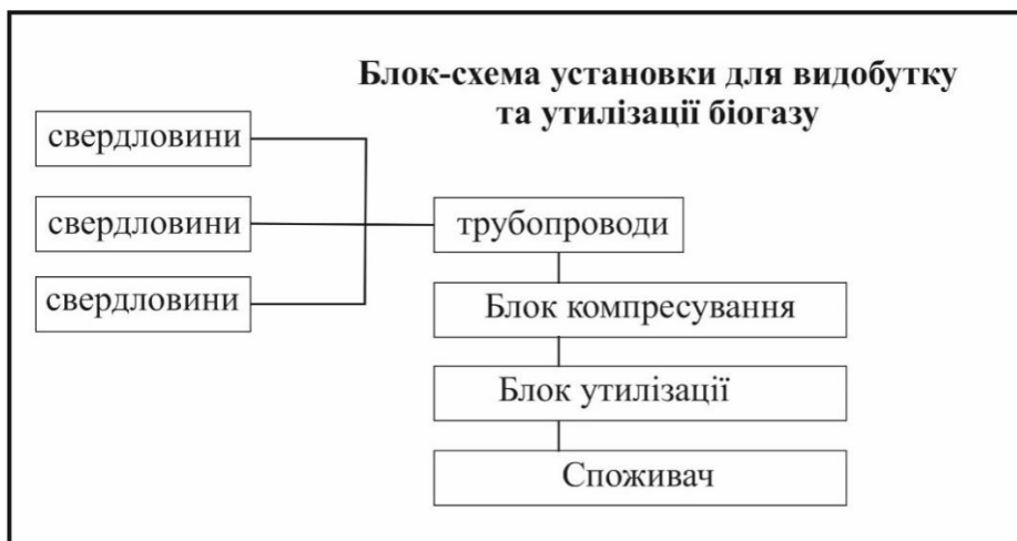
Рис. 1 Принципова технологічна схема системи зі збору звалищного газу
