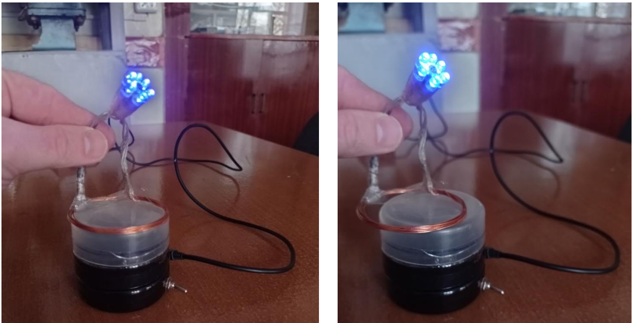
Рис. 2 Практичне дослідження системи безпроводної передачі електроенергії
