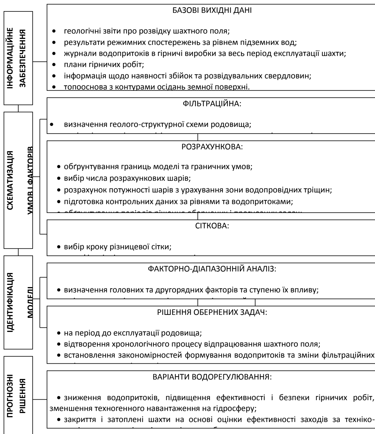
Рисунок 1 – Концептуальна схема побудови та використання постійно діючої геофільтраційної моделі шахтного поля
