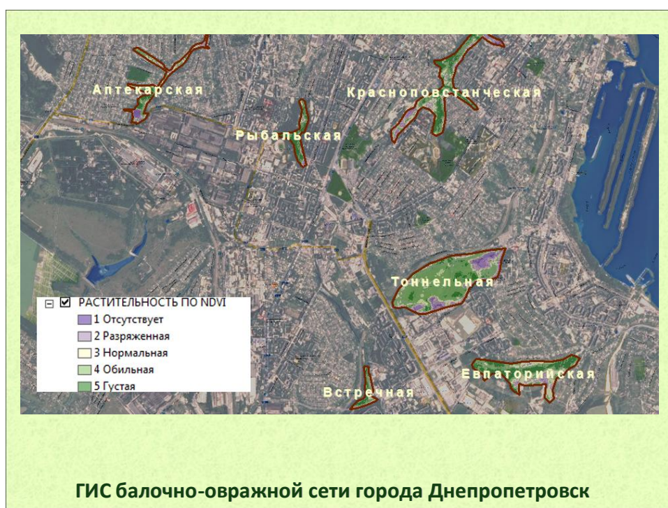
Рисунок 6.2– Цифровая модель балочно-овражной сети, где глубина оврагов выделена в отдельный слой, а сами овраги оконтурены
