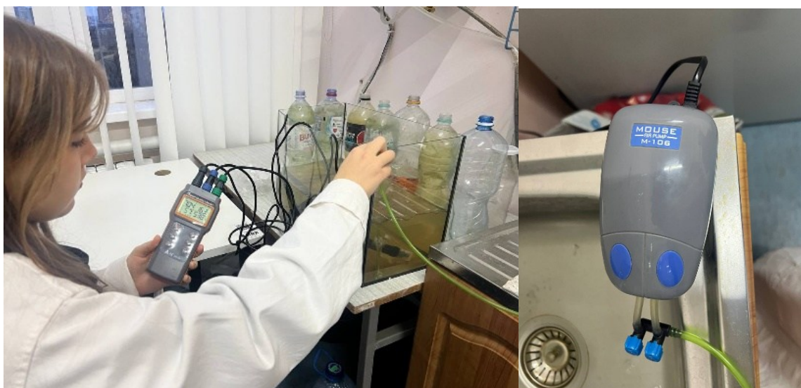
Рис. 7.1 – Дослідження розчиненого кисню у воді з використанням комплексного аналізатора і повітряного компресора в лабораторії кафедри екології та ТЗНС
